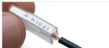
Kovani sıkıştırın ve etiketlenecek iletkenin üzerine kaydırın.
