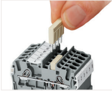
İtmeli tipte bir köprü takın ve yuvaya oturuncaya kadar aşağı itin.
